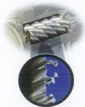
通常无油螺杆空压机的主机和机壳的内表面都涂有特氟龙即聚四氟乙烯材料，起到防腐和减少啮合间隙的作用。但由于聚四氟乙烯材质较软，经不起高温、高压气体的长期冲刷，容易剥落，从而造成齿间间隙增大，导致 1~2 年后供气量下降 10~15%，并且在运行 30000 ~ 40000 小时后必须更换二级主机，为此英格索兰公司经过长期不懈地研究，取得了突破性进展，**在主机**的转子和压缩腔内壁涂有坚固的**超级涂层(UltraCoat)**以防止腐蚀和涂层脱落的发生。
